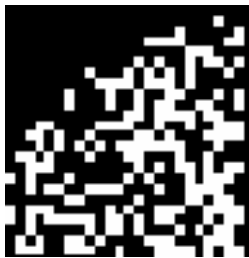
Fig.VI.3 : faisceau du générateur de nombres aléatoires, avant centrage. On remarque la section circulaire du champ de speckle, à l'intérieur de laquelle les étiquettes prennent des valeurs aléatoires.
