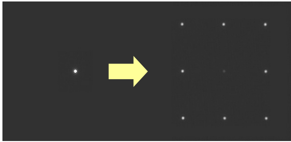
Fig.B.2 : Réponse impulsionnelle du CGH (voisinage d'ordre 2) - image réelle CCD.
