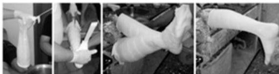
**Figura 5:** Processo de fabricação de órteses por meio da digitalização 3D de baixo custo. Fonte: Brendler et al. (2014)
